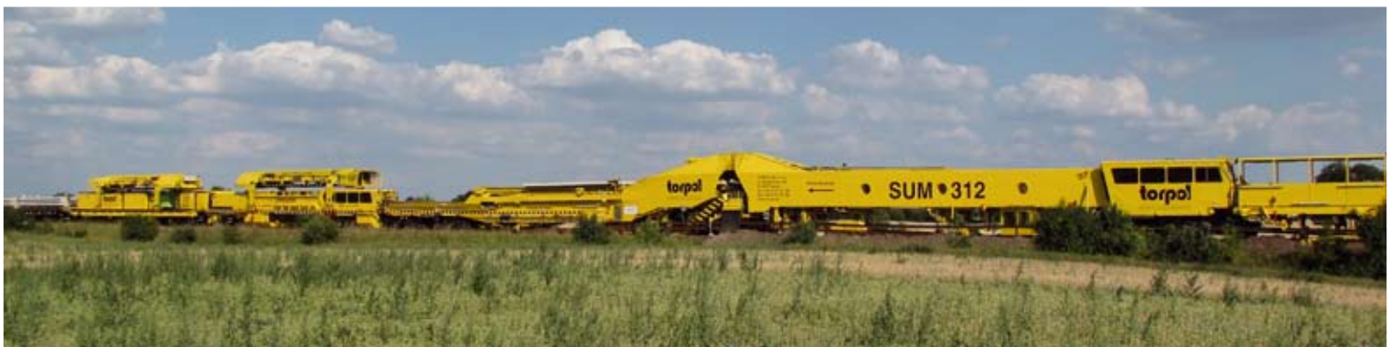
Uniwersalny pociąg do wymiany nawierzchni kolejowej SUM 312 SUM 312 track renewal machine
